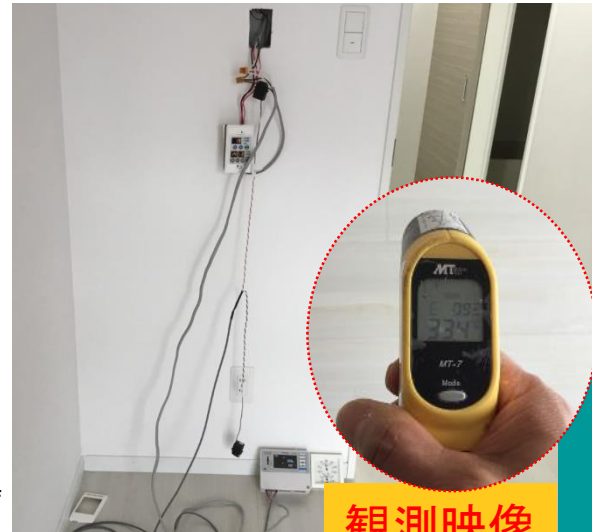
試験器PANASONIC エネミエールS 測定負荷40度設定 設定温度に達した時 コントロールスイッチへの電力供給OFF (電気量0.00KW)
