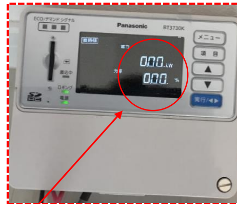
試験器PANASONIC エネミエールS 測定負荷40度設定 設定温度に達した時 コントロールスイッチへの電力供給OFF (電気量0.00KW)
